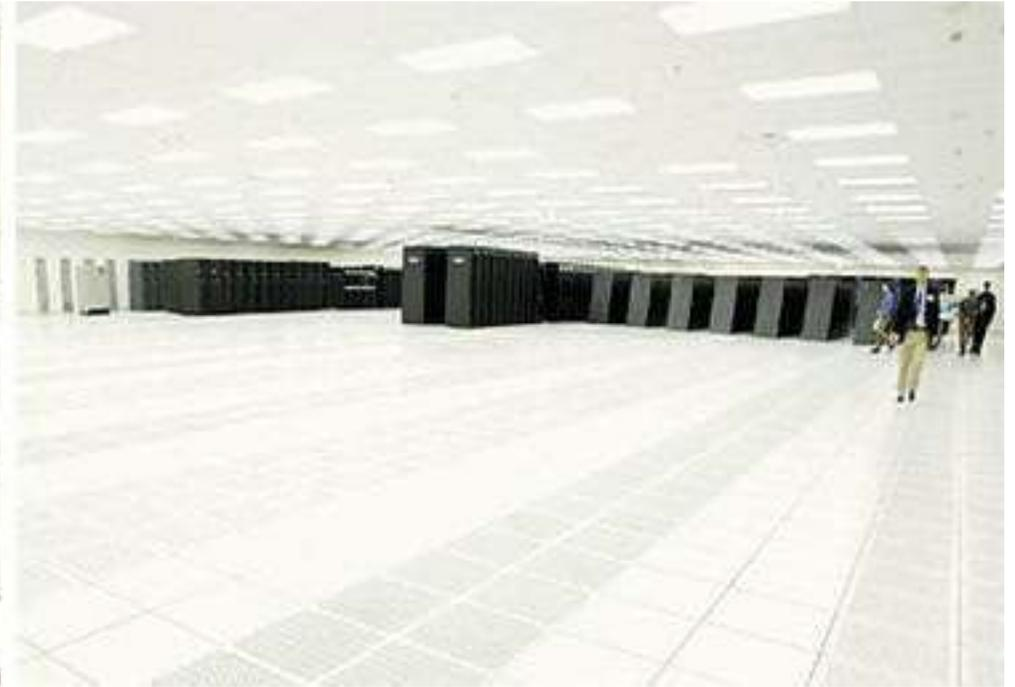
O **Blue gene** é um super-computador construído pela IBM para estudar *folding* de proteínas. Esta máquina ocupa metade de um campo de tênis. A 14 de Novembro de 2005 executava  $280.6 \times 10^{12}$  operações matemáticas por segundo.
