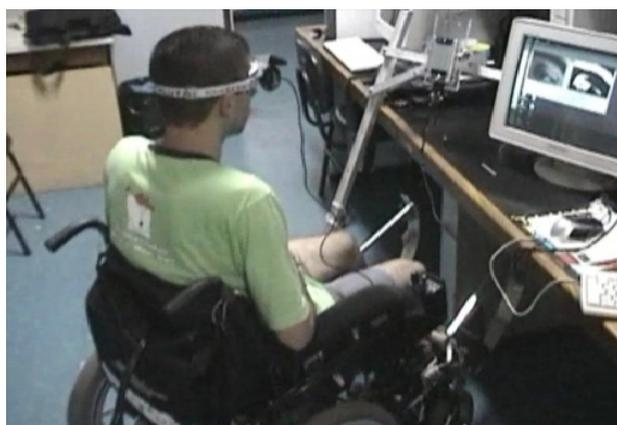
**Figura 5.15.** Uso del interfaz accionado por movimientos del globo ocular para comando de la silla de ruedas robotizada.
