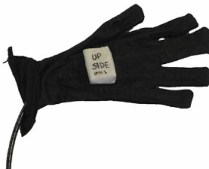
**Figura 3.7.** Vista del guante con el sensor inercial.
