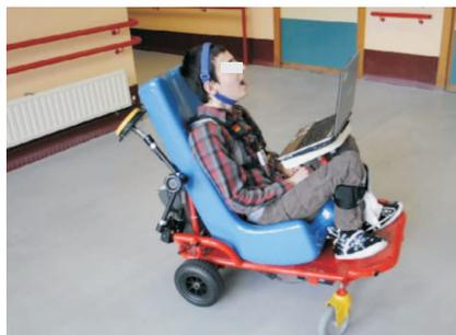
**Figura 3.19.** Niño con PC conduciendo el vehículo PALMIBER con la interfaz ENLAZA (por movimientos de cabeza).
