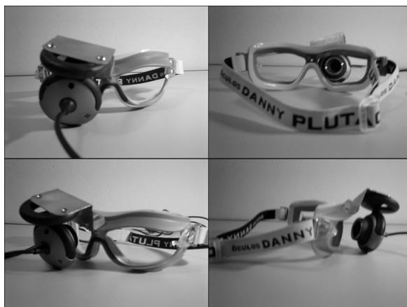
Figura 5.8. Gafas utilizadas para el seguimiento del globo ocular.
