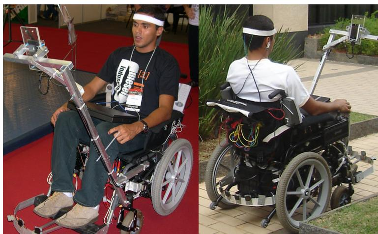
**Figura 6.9.** Comando de la silla de ruedas robotizada de la UFES/Brasil a partir de patrones ERD/ERS.
