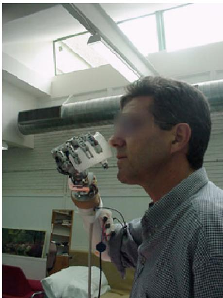
**Figura 4.6.** Pruebas de manipulación con la prótesis MANUS-HAND.
