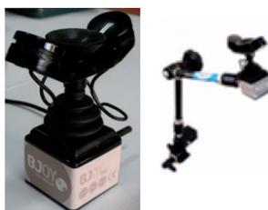
**Figura 2.10.** Joystick para controlar con el mentón, destinado, por ejemplo, a personas con cuadruplejía (<http://www.bj-adaptaciones.com>).
