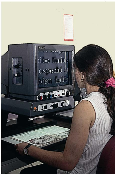
Figura 8.1. Lupa electrónica.
